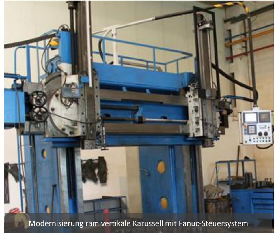
Modernisierung ram vertikale Karussell mit Fanuc-Steuersystem
