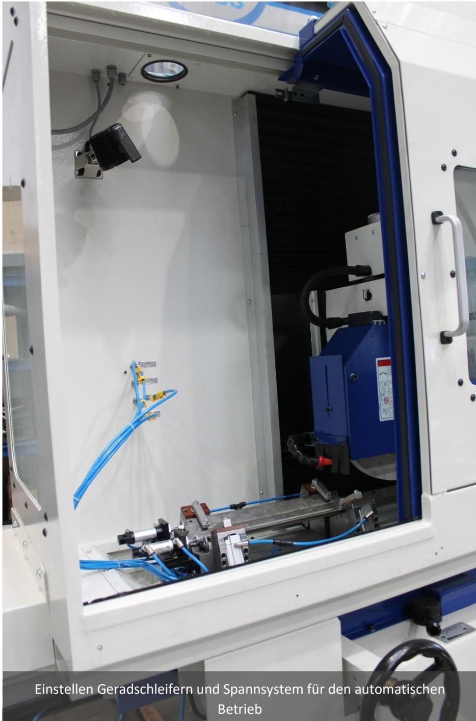
Einstellen Geradschleifern und Spannsystem für den automatischen Betrieb
